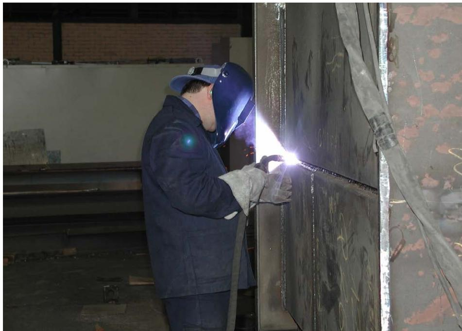
Bild 5.3.3: Schweißen einer Quernaht mit Schweißverfahren 135 MAG (Metall- Aktivgas)
