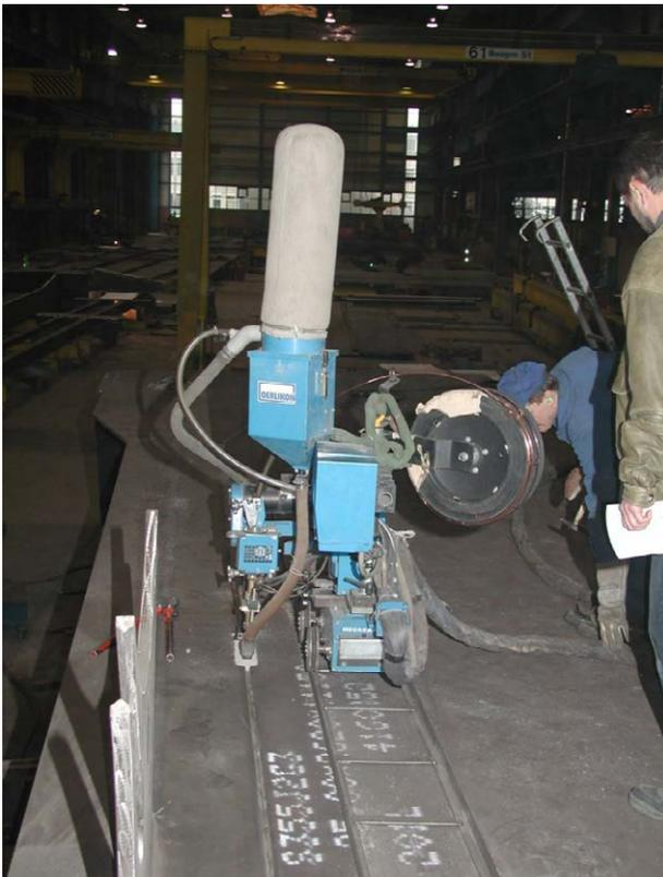
Bild 5.3.1: Schweißen einer Längsnaht mit Verfahren 111 PU (unter Pulver)
