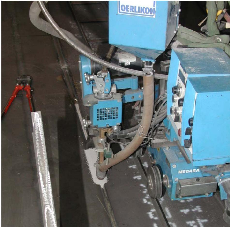
Bild 5.3.2: Schweißen einer Längsnaht mit Verfahren 111 PU (unter Pulver)
