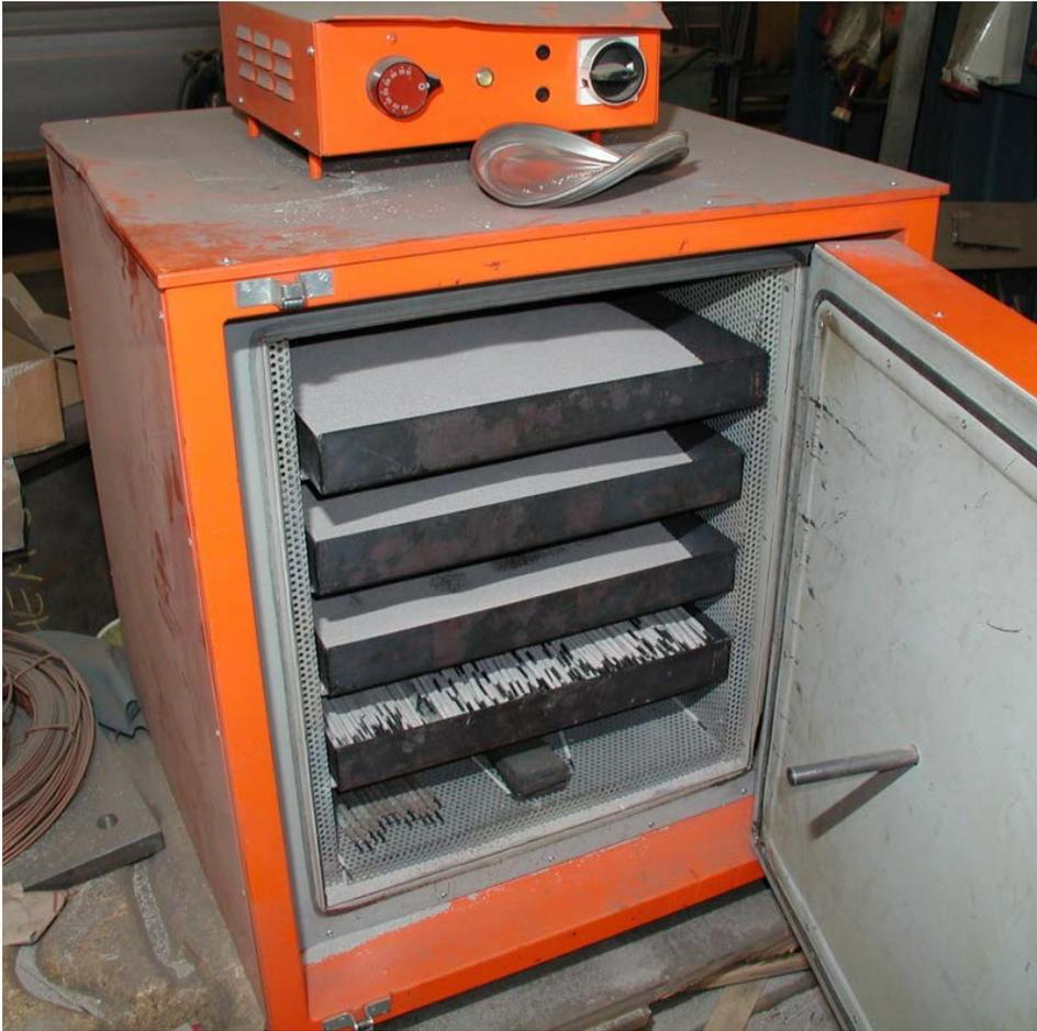
Bild 5.3.4: Ofen zum Rücktrocknen basischer Schweißzusatzstoffe (Pulver Elektroden)
