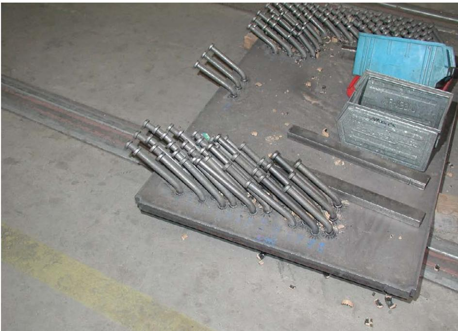
Bild 5.3.5: Prüfung von Kopfbolzen
